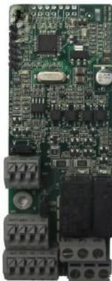
IO expansion card EC-IO501-00
