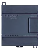
Internet Technology module CP 243-1 IT max. 1 module
